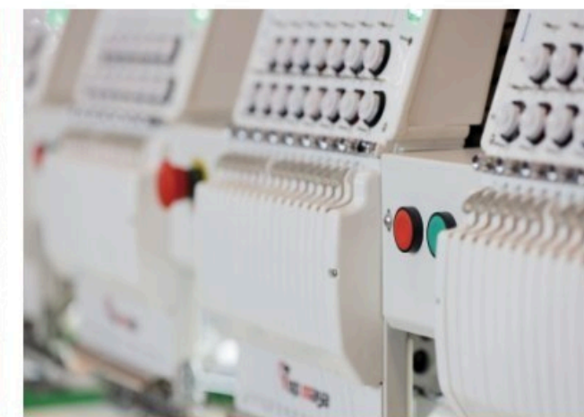
急停及多位置启停按钮方便操作 Emergency Stop And Convenient Start/stop Button
