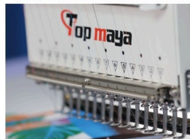
面线夹持锁线功能 Upper Thread Hold System
