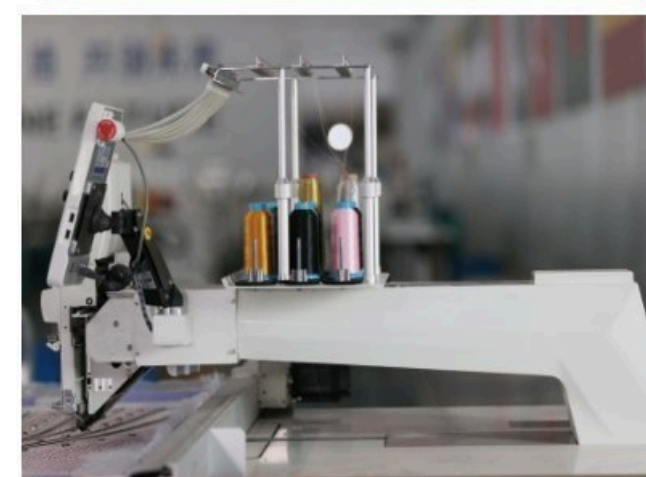
H机头结构支持更大绣作范围 H Type Head Structure
